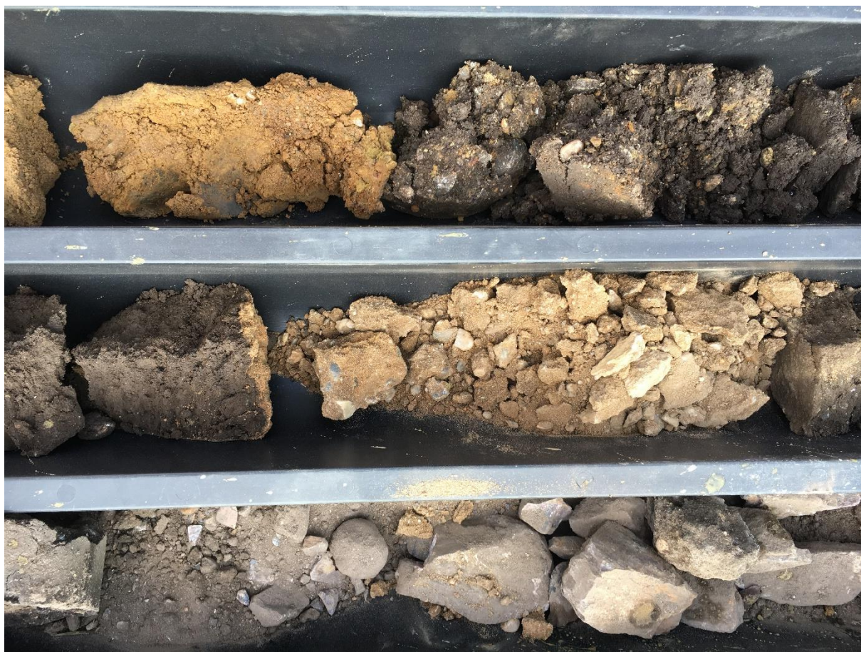
Dokumentace sondy J1 – navážkové horizonty, šterky a písčité jíly
